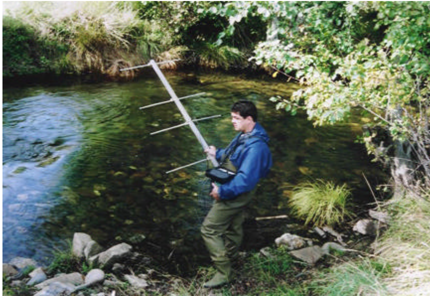
Figura 18: Operador manuseando o aparelho de rádio associado à antena para captação de sinais acústicos (Outubro 2002).
