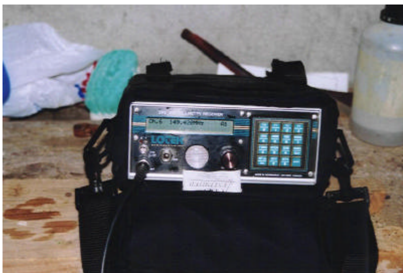
Figura 17: Aparelho receptor e processador de sinal rádio - modelo LOTEK (Outubro 2002).
